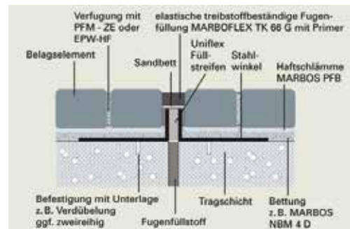
Oberbau eines Reihenverbandes in gebundener Bauweise
